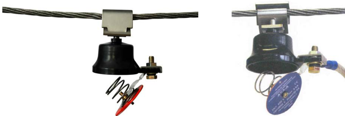
Rys. 16. Ograniczniki warystorowe ASA-A ( I_n = 5 kA oraz 10 kA) firmy APATOR po zadziałaniu odłącznika odłączającego przewód uziemiający; sygnalizatorem jest spodnia pokrywa niebieska po jednej i czerwona po drugiej stronie
