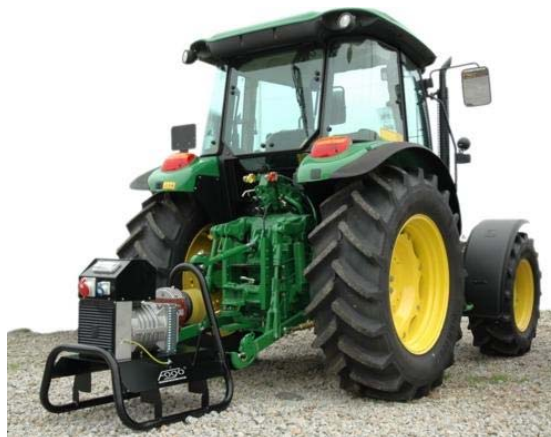
Rys. 6. Prądnica zespołu prądotwórczego ciągnikowego sprzężona z ciągnikiem
